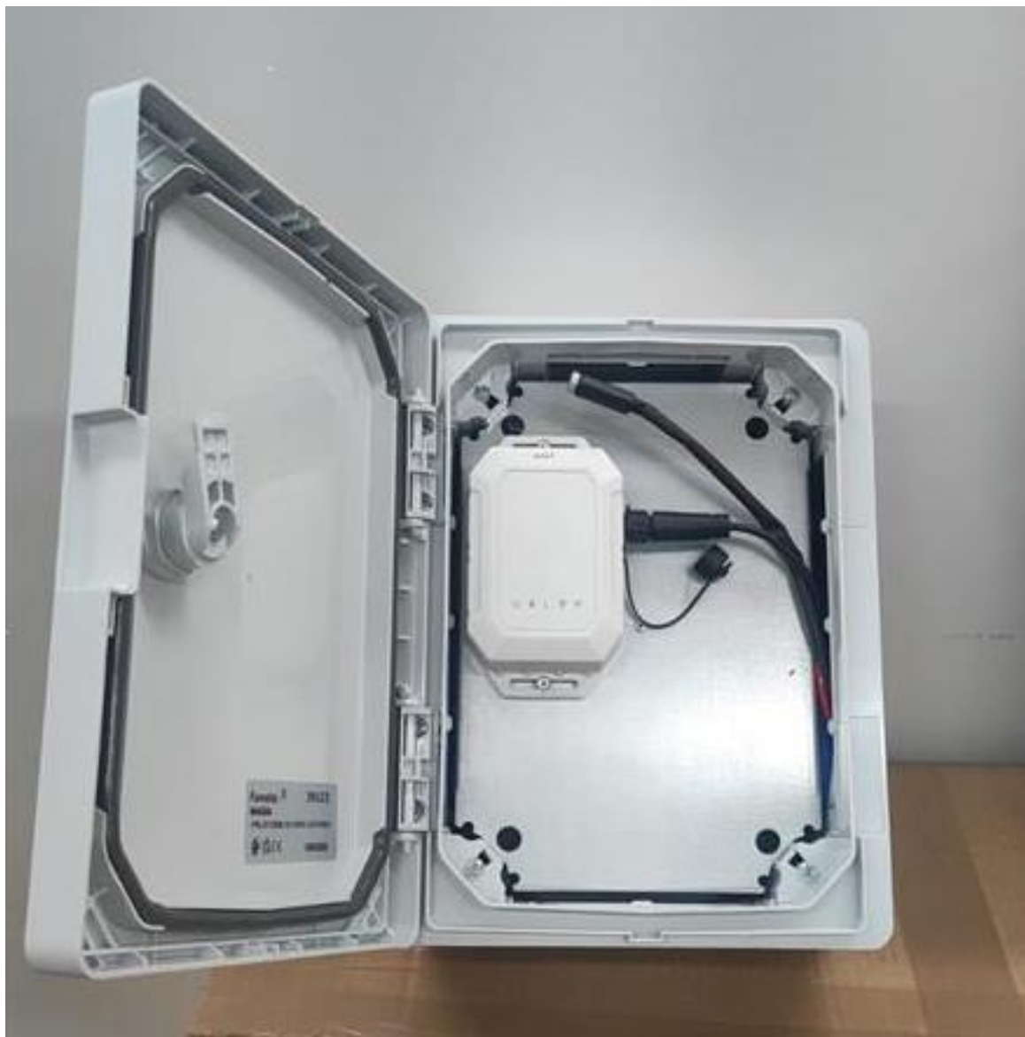
Figura 6 — Painel montado com rastreador e bateria de 50Ah.
